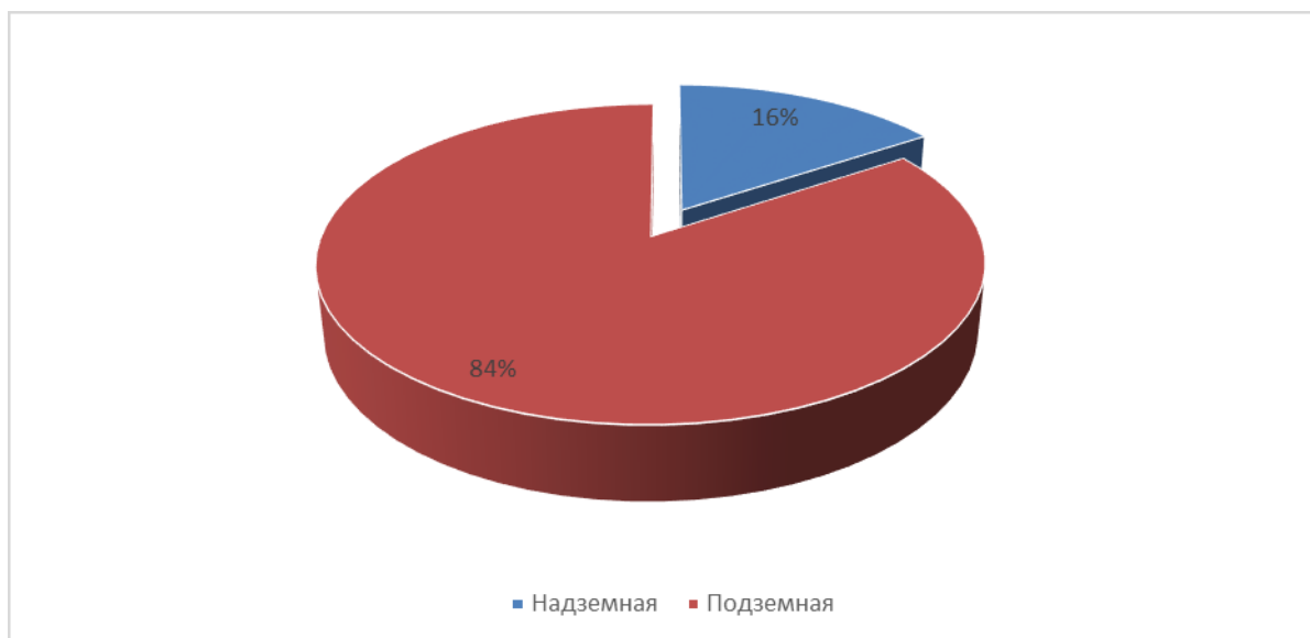
Рисунок 1.3 - Распределение суммарной протяженности тепловых сетей по способам прокладки
