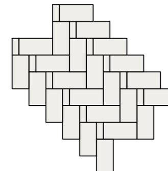
Типовой элемент раскладки мощения №2. "МОДЕРН" 250\*500\*60 мм., 100\*250\*60 мм. Цвет белый
