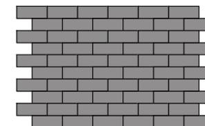
Типовой элемент раскладки мощения №3. "МОДЕРН" 100\*250\*60 мм. Цвет серый
