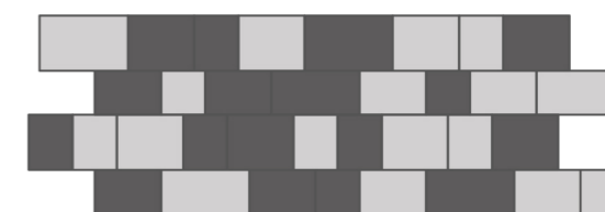
Типовой элемент мощения №1. Коллекция "BENELUX" толщина 60 мм. Цвет светло-серый и чёрный.
